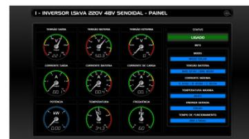
Disponibiliza uma interface amigável e completa do status do inversor, proporcionando a leitura fácil das principais variáveis do sistema, além das leituras máximas e mínimas, valores acumulados e indicação de alarmes. Pode ser acessado pela internet ou rede local através de qualquer dispositivo (Smartphone, computador), utilizando o browser de sua preferência.
