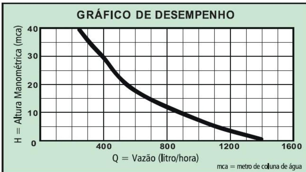
Obs.: As vazões da bomba estão sujeitas a variação devido ao nível de irradiação solar da região e condições meteorológicas.
